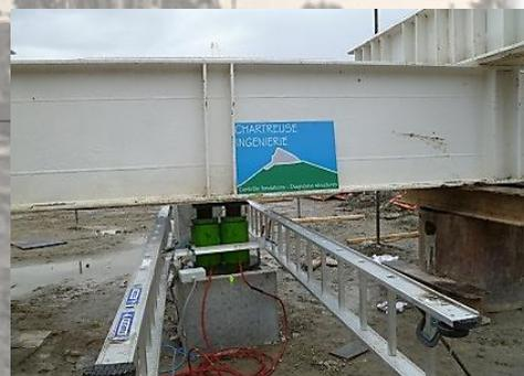
Essai de chargement statique sur pieu avec mesures des déformations par extensomètres
