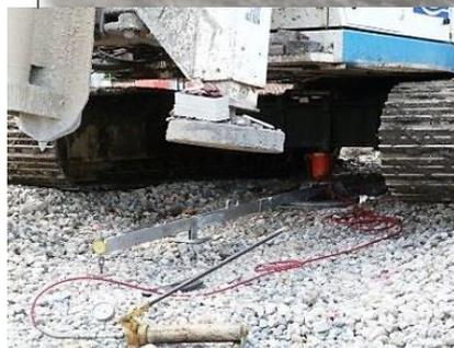
Essai de chargement statique sur colonne ballastée
